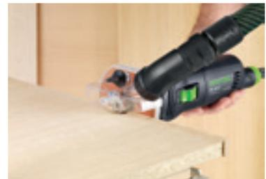
Bündigfräsen von Kunststoff- oder Massivholzleimern.
