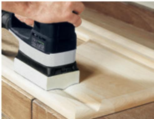
**Profilschleifschuhe nach Maß**
