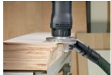
Fasefräsen von Kunststoff- oder Massivholzleimern.
